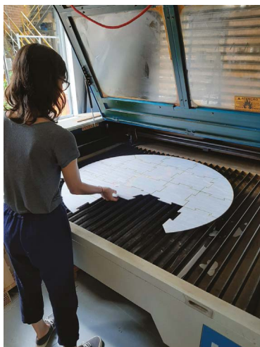
Figura 87 – Produção do tabuleiro de madeira em máquina de corte a laser. Fonte: Luciano Alvares.
