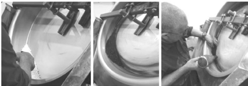
**Figura 7.14** – Revestimento de grânulos de ureia. **À esquerda:** Adição de uma mistura de argila úmida e pó de biochar aos grânulos de ureia em um aglomerador de placas. **Ao centro:** A argila e o biochar estão revestindo os grânulos de ureia. **À direita:** Secagem dos grânulos com um secador de cabelo
