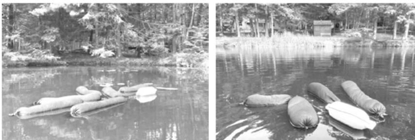
**Figura 7.8 – À esquerda:** Sacos cheios de biochar em um lago carregado de nutrientes. **À direita:** Os sacos cheios de biochar adsorveram os nutrientes da água do tanque, resultando em um tanque de água limpa.<sup>19</sup>
