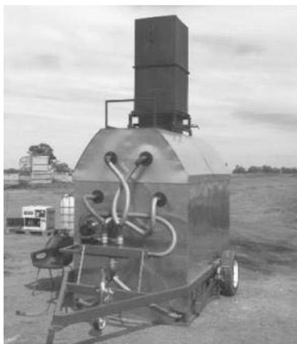
**Figura 3.7** – O forno portátil de quatro metros cúbicos Big Roo projetado para palha. (para obter mais informações acesse: [www.allthingsbiochar.com.au](http://www.allthingsbiochar.com.au))
