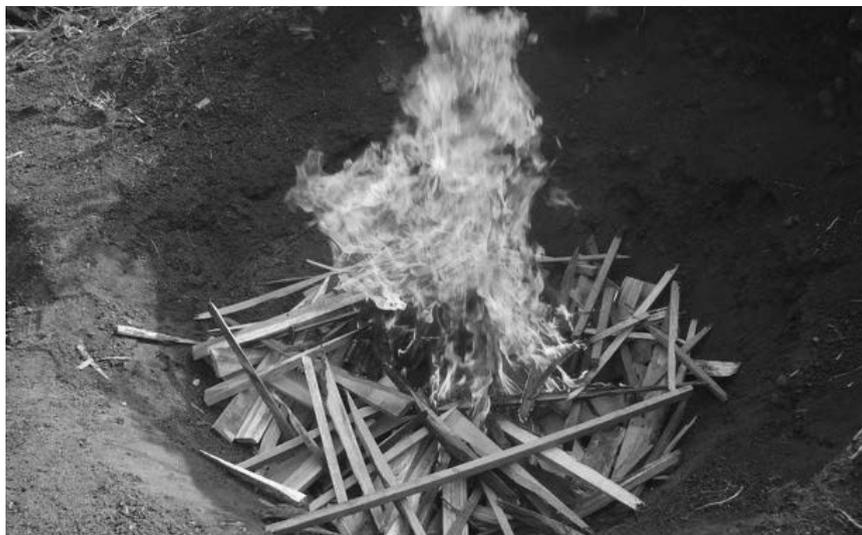
**Figura 3.2** – Queima aberta com chama superior em um poço. A colocação de gravetos no fogo continua até que o forno esteja cheio de carvão. (Foto: Pacific Biochar - [pacificbiochar.com/open-pit-biochar-production](http://pacificbiochar.com/open-pit-biochar-production))
